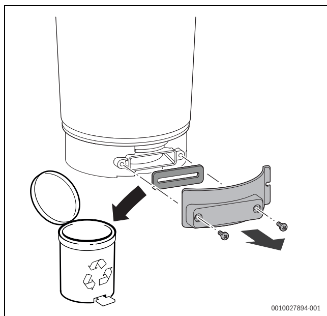
Obr. 65 Otevření revizního otvoru
