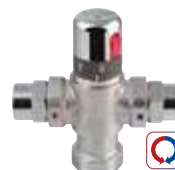
TMTCOM Termostatický směšovač 1" 4 až 8 odběrných míst, 20-50 °C, F1"xF3/4" zpětná klapka, filtr 3 390,- / 138 €
